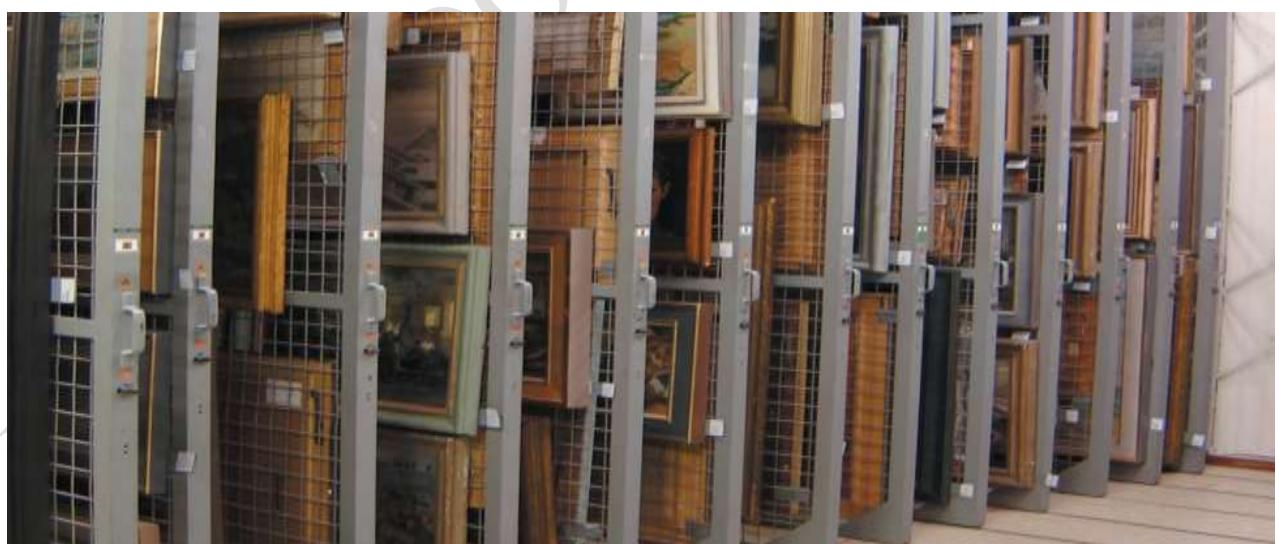
Se proveerán y colocarán 25 (veinticinco) bastidores para colgar cuadros. Los bastidores deberán ser de 220 cm x 220 cm y se ejecutarán en perfilería L, de acero estructural de 25 mm x 25 mm x 3 mm, los empalmes de la perfilería se ejecutarán con
