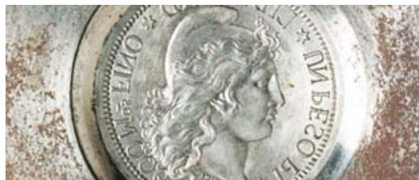
Pantógrafo realizando la réplica en tamaño real. Retoques manuales del punzón. Cuño.
